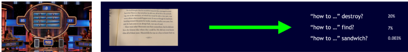
Figure 3.2 : Un llm est une fonction allant du contexte (une séquence de tokens) à une distribution de vraisemblance des tokens suivants potentiels.
